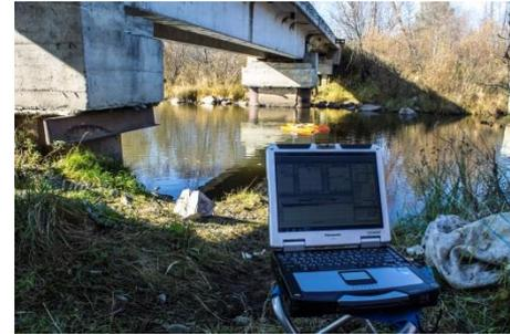
Измерение расходов воды с помощью профилографа
