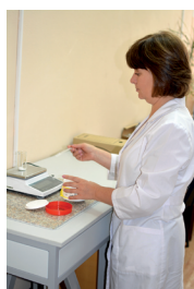
ЦЛОМ. Взвешивание реактивов при подготовке растворов для определения марганца в поверхностной воде
