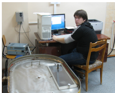
Ведущий инженер-метролог ССИ С. С. Абрамов работает с установкой компараторной для поверки гидрометрических вертушек
