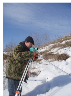
Нивелировка гидрологического поста
