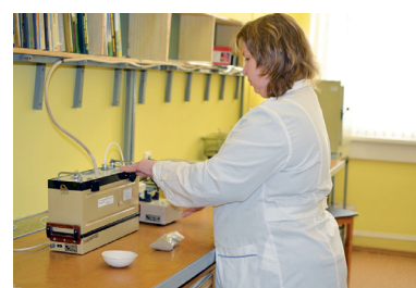
ЦЛОМ. Анализ проб почвы на анализаторе ртути АГП-01М
