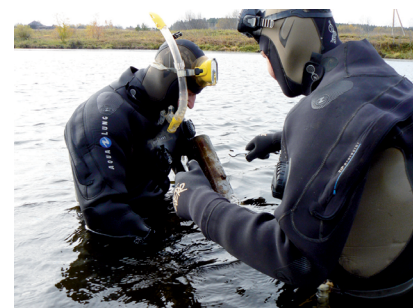
ГП Кировское, река Нейва — установка гидростатического датчика на дно реки водолазами
