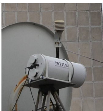
Метеорологический температурный профилемер МТП-5
