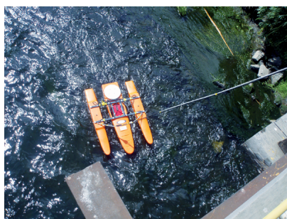
Работа профилографом с моста
