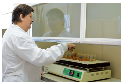
ЦЛОМ. Подготовка проб атмосферного воздуха для определения металлов на спектрометре
